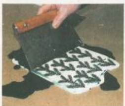
Hier streicht Heinz Melzl von der Firma Hueber gerade das überschüssige Wachs von einer Form aus Siliconkautschuk ab.
